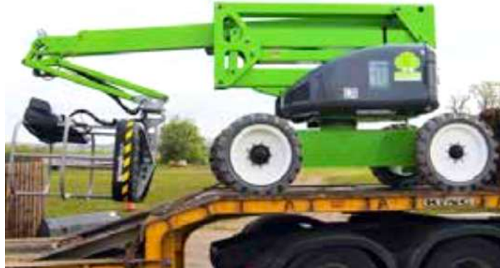
Amarrage par frottement d'un PEMP
