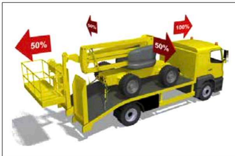
Forces de fixation sur l'arrimage de la cargaison.
