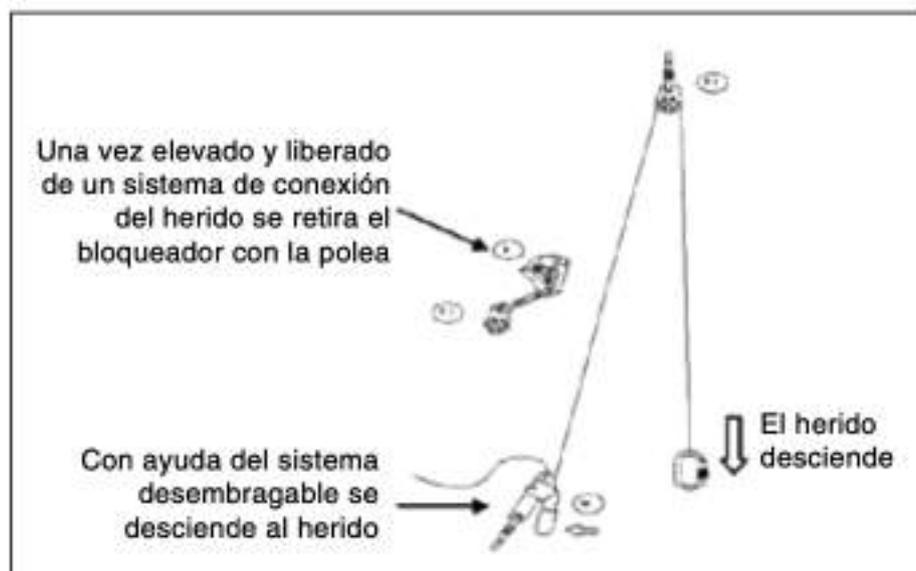
Una variante de esta técnica consiste en poner el sistema desembragable en el anclaje por encima del herido en vez de la polea y realizar ahí el polipasto, de manera que una sola persona puede realizar el rescate.
