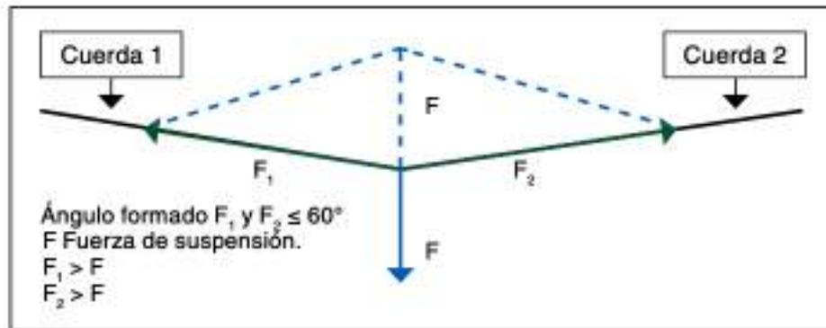
El punto de anclaje principal debería colocarse preferentemente en el tronco del árbol o en ramas principales y tener una resistencia mínima de 1200 daN, en base la norma UNE-EN-795.
