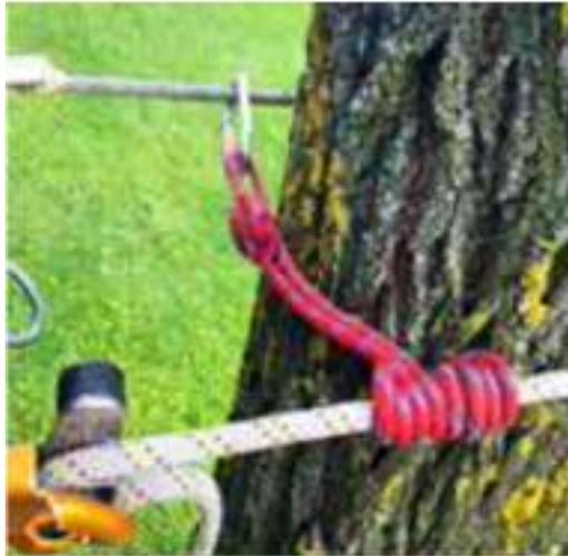
2. Colocar una cinta o cuerda regulable (UNE-EN 795) y unir a ella la eslinga para que en caso de caída ahorque la cuerda sobre el tronco. Con este sistema se debe comprobar que los conectores y piezas metálicas trabajan correctamente. En ambos sistemas, el desplazamiento a lo largo del tronco no es fácil y se deben llevar guantes. Estos métodos se deben utilizar junto al a) o b).
