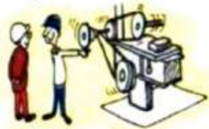
■ Máquinas sin protección
