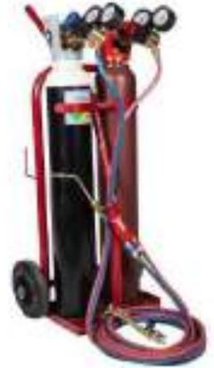
✓ **Soplete:** efectúa la mezcla de gases. Se compone de dos conexiones con las mangueras, dos llaves de regulación, el inyector, la cámara de mezcla y la boquilla.
