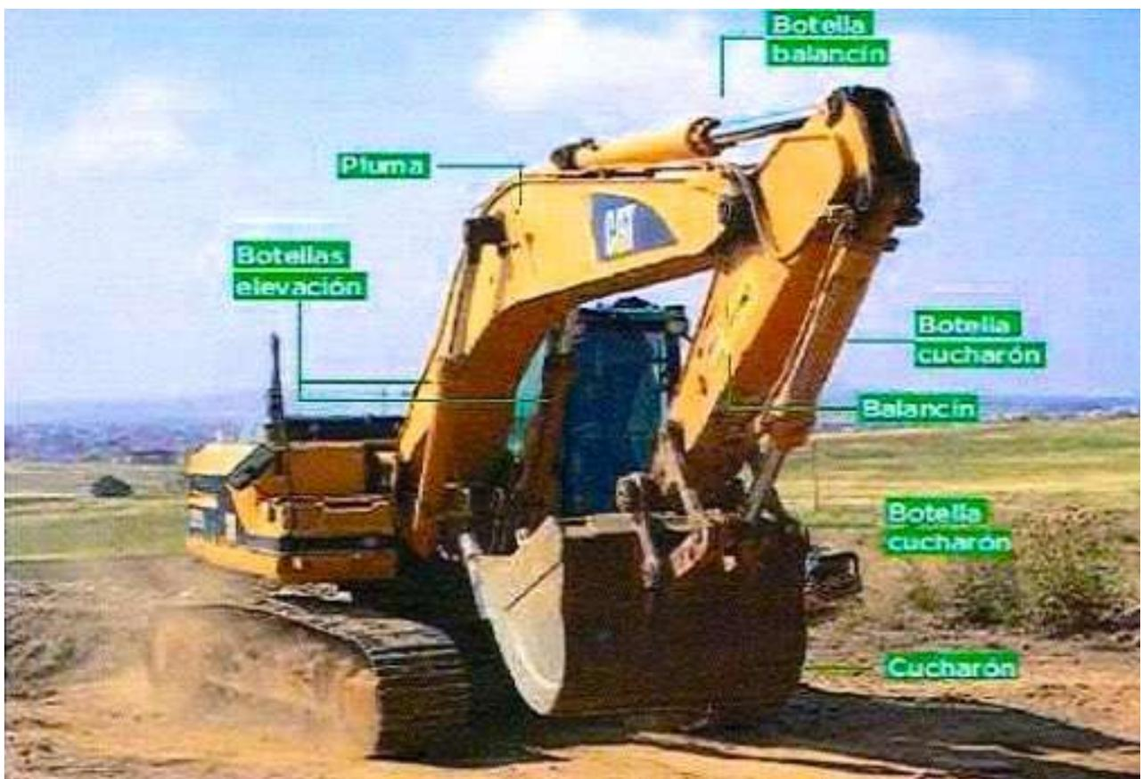
Esta máquina se usa, preferentemente, en excavaciones y vaciados de zanjas, trabajos de demolición, carga sobre vehículos, extracción de materiales bajo el nivel del suelo y construcción de taludes. Es apropiada para toda clase de terrenos. **Tiene dos movimientos:**
