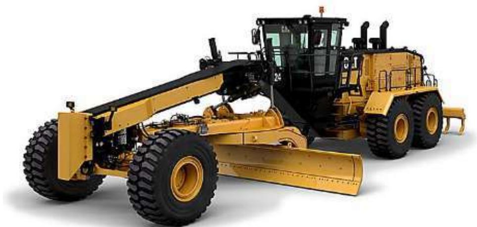
Muchas motoniveladoras llevan montado un escarificador justo delante de la hoja vertedera. Este implemento se sube o se baja hidráulicamente, y se utiliza para disgregar los materiales y así facilitar el trabajo de la Motoniveladora. También se puede colocar un ripper, en la parte trasera de la máquina y una hoja convencional de bulldozer, en la parte delantera.
