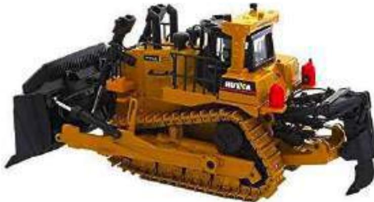
El bulldozer es una máquina usada para distancias cortas y sobre todo en terrenos con fuertes pendientes. Con esta máquina se debe trabajar a favor de la pendiente de forma que se aproveche la fuerza de la gravedad.
