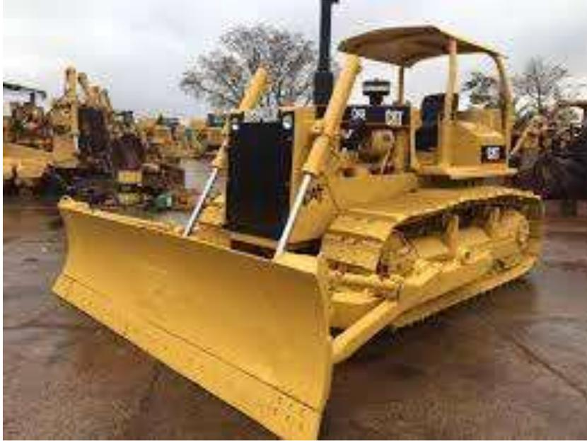
**Tildozer:** hoja de empuje gira o pivota en un plano vertical sobre el eje longitudinal de la máquina.
