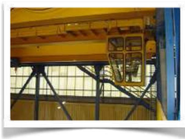
La cabina de mando sobre el propio puente grúa ofrece una mayor visibilidad sobre las cargas a manejar y esta principalmente indicado para la manipulación de cargas voluminosas.
