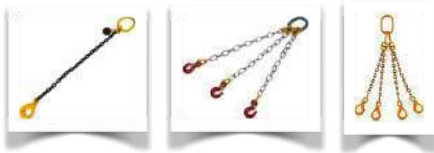
La capacidad carga de trabajo de una eslinga, del tipo que sea, dependerá del ángulo formado por los ramales que sustentan la carga. De esta manera, para una eslinga de dos ramales, la capacidad de carga disminuye a medida que aumenta el ángulo formado por sus ramales.
