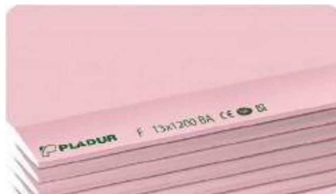
**PLADUR A1** (incombustible): Placa constituida por un alma de yeso, reforzada con incorporación de fibra de vidrio y cuyas celulosas superficiales han sido sustituidas por velos continuos de fibra de vidrio.
