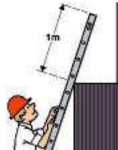
La **inclinación de la escalera** deber ser tal que la distancia del pie a la vertical pasando por el vértice esté comprendida entre el cuarto y el tercio de su longitud, correspondiendo una inclinación comprendida entre  $75,5^\circ$  y  $70,5^\circ$ .
