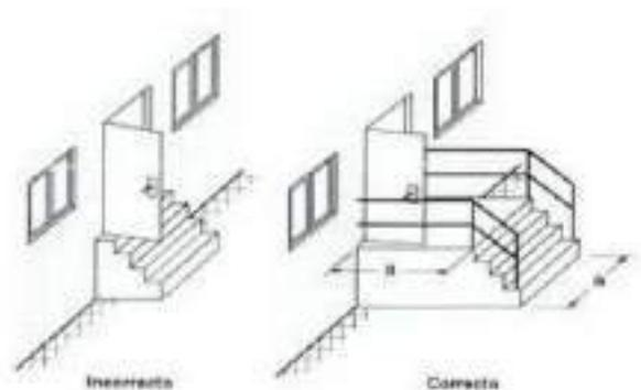
Las aberturas o desniveles, **cuya altura de caída sea igual o superior a 2 metros** se protegerán mediante barandillas u otros sistemas de protección de seguridad equivalente.
