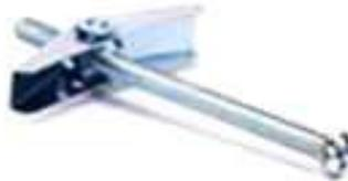
Los **anclajes de gravedad o palanca** como su nombre sugiere trabajan por gravedad, son parecidos a los anclajes de palometa, pero el mecanismo de apertura de las alas no es automático; se trata de una articulación de 90 grados, que una vez abierta se fija con un tornillo, de manera que cuando se aprieta se sujeta a la parte posterior de la placa. Es sencillo de utilizar y funciona muy bien con medias cargas.
