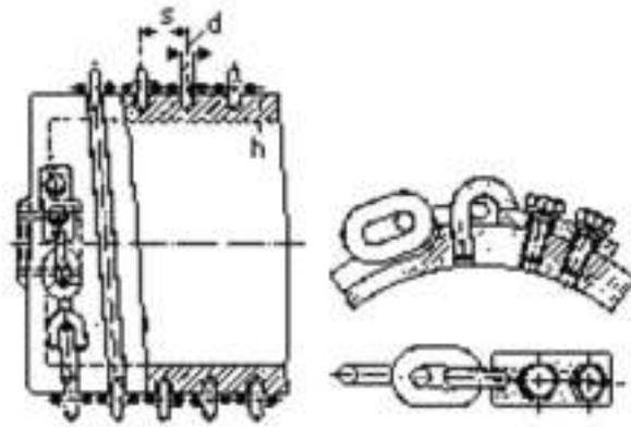
**Fig. 6: Fijación de la cadena sobre el tambor**
