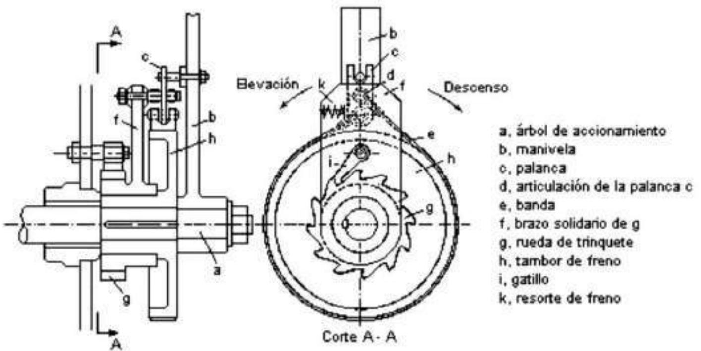
**Fig. 4: Manivela de seguridad**
