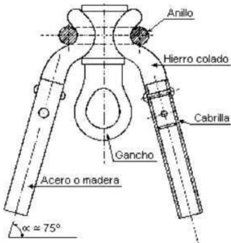
**Fig. 8: Unión terminales cabrillas**
