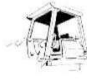
B) ESTRUCTURA CON 4 PUNTALES CON TECHO
