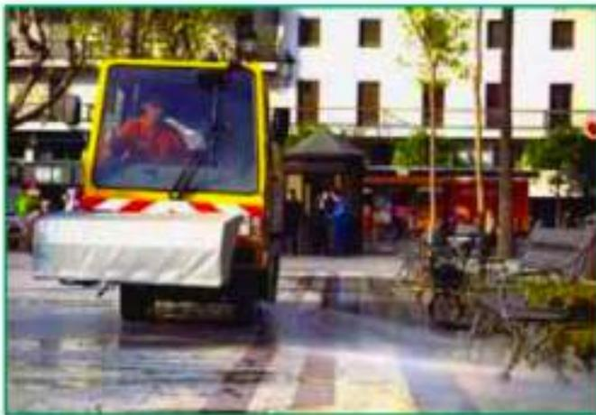
*La baldeadora de alta presión, dispone de una barra de boquillas en la parte frontal de la máquina que proyectan chorros de agua a pocos centímetros del suelo. Su acción es muy eficaz contra las manchas del pavimento y para el arrastre y disolución de los excrementos caninos. Su uso está restringido a las superficies que permiten su maniobra, y soportan su peso.*
