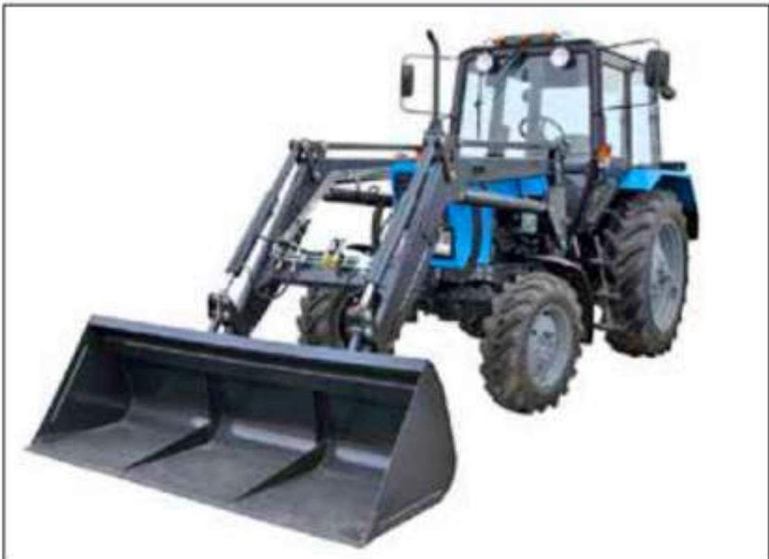
*Figura 2. Cargador frontal acoplado a tractor.*
