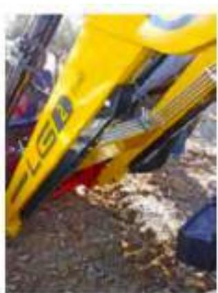
Figura 7. Dispositivo de bloqueo de los soportes.
