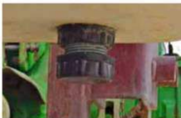
Figura 15. Tapón para vaciado del depósito que no permite dirigir el líquido fuera del alcance del operador.
