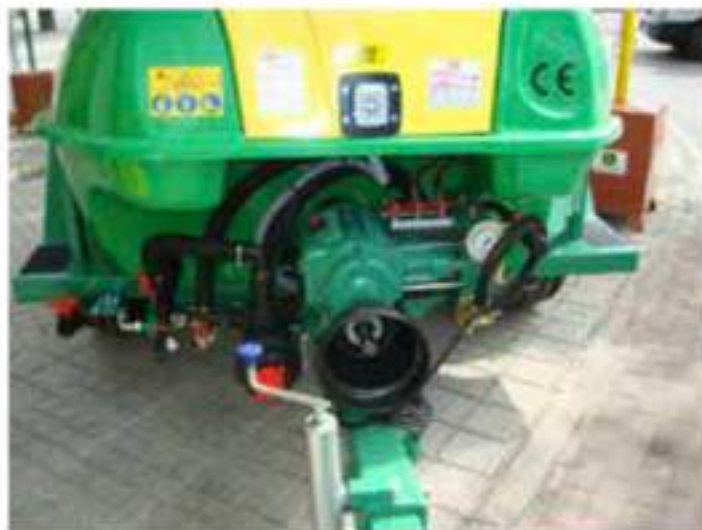
Figura 5. Riesgo de caída durante el acceso al depósito del atomizador (peldaño de dimensiones insuficientes).
