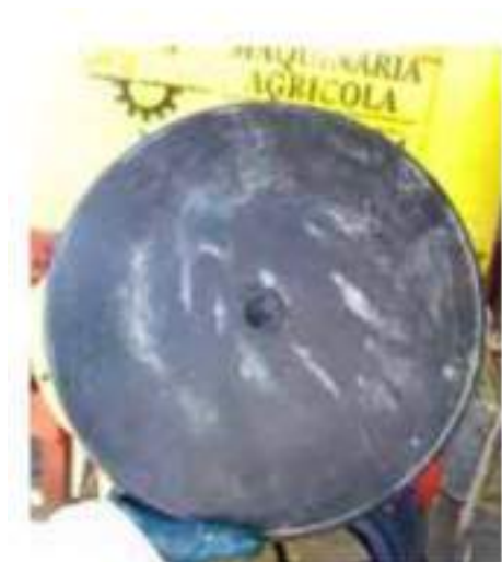
Figura 13. Orificio compensador de presiones en la tapa del depósito.
