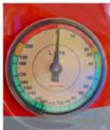
Figura 12. Indicador de nivel integrado en la carcasa del frontal de la máquina.
