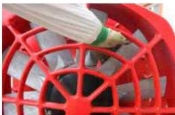
Figura 19. Resguardo incorrecto en la zona de aspiración del ventilador.
