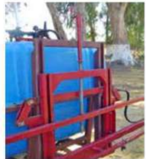
Figura 8. Dispositivo manual de regulación de la altura de la barra.
