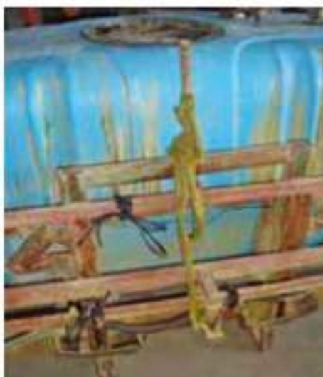
Figura 3. Impacto debido al movimiento (barra sin sujeción adecuada).
