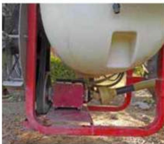
Figura 2. Atrapamiento en la transmisión de potencia al ventilador (poleas y correas sin resguardo).
