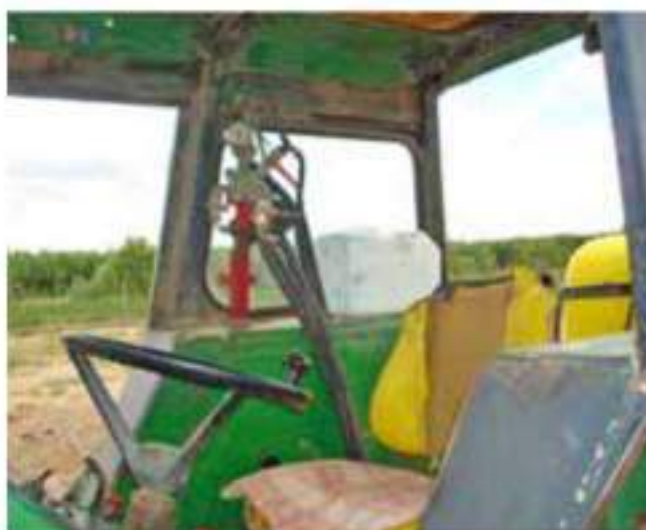
Figura 4. Proyección de fluidos a presión (distribuidor y tuberías ubicadas dentro de la cabina).
