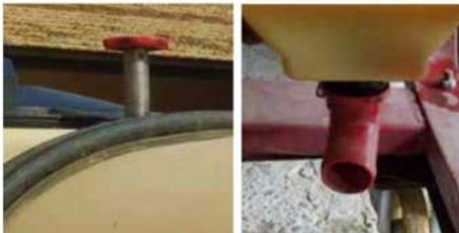
Figura 14. Dispositivo de vaciado del depósito.
