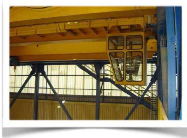
La cabine de l'opérateur sur le pont roulant lui-même offre une meilleure vue sur les charges à manipuler et convient principalement à la manutention de charges volumineuses.
