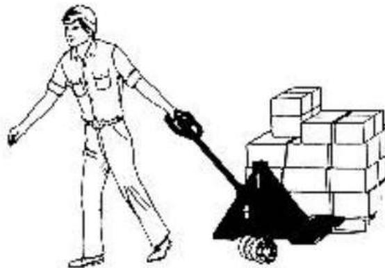
Figure: Traction en position de travail
