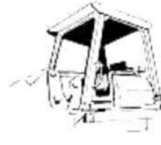
B) STRUCTURE À 4 POINTS AVEC TOIT
